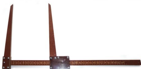
Рисунок 3. Мерная вилка для измерения диаметра ствола
