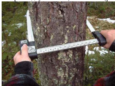
Рисунок 3. Мерная вилка для измерения диаметра ствола
