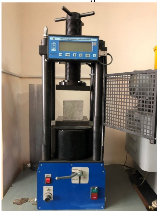
Рис. 1. Гидравлический пресс МГ-100 с приставкой
