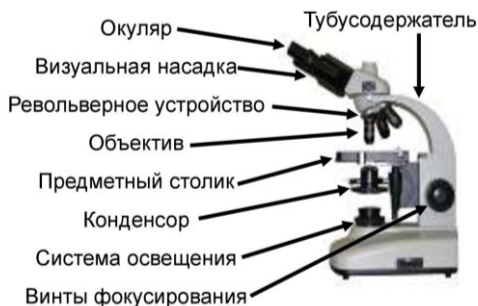
Рис. 4.2. Устройство светового микроскопа.
