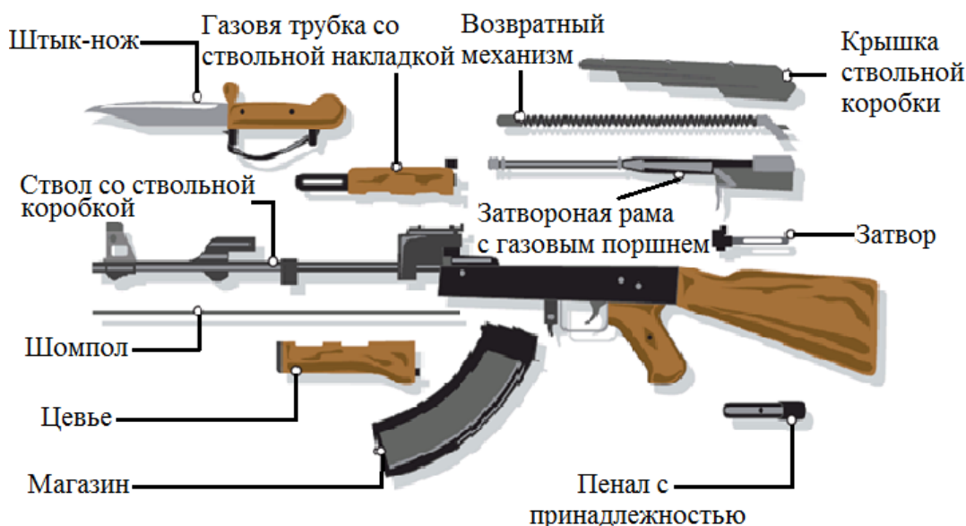
Рис. 16. Части и механизмы автомата АК-74М
