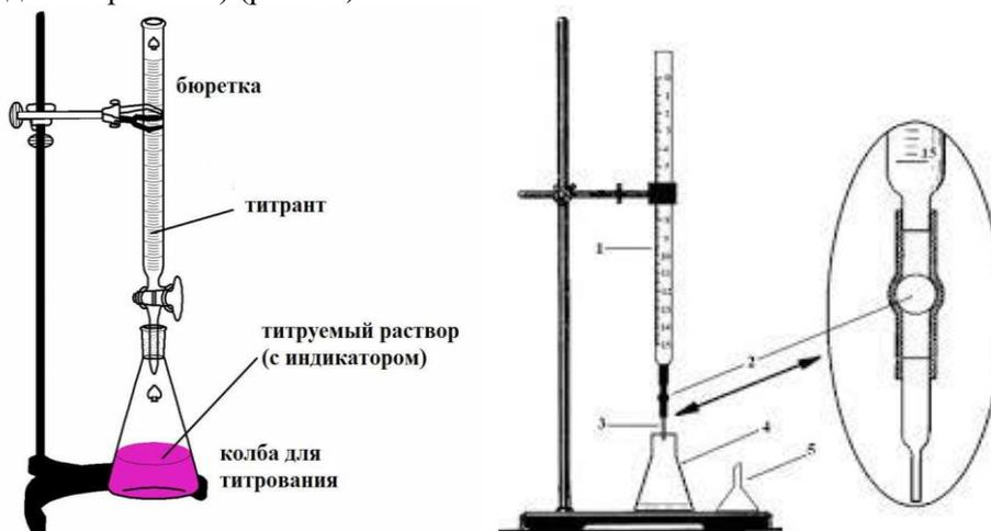
Рис. 62. Установка для титрования в кислотно-основном титровании
