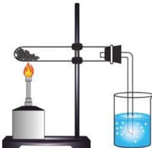
Рис. 18. Установка для получения газов термическим разложением твердых веществ
