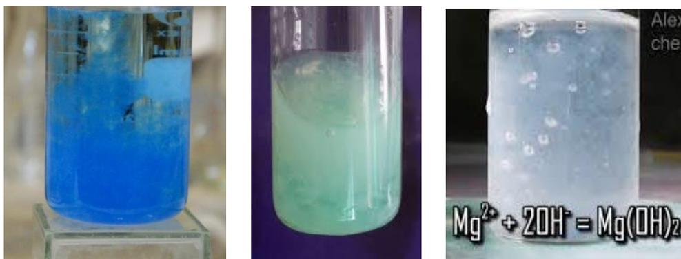
Рис. 31. Получение оснований: 1 – гидроксида меди (II), 2 – гидроксида никеля (II), 3 – гидроксида магния
