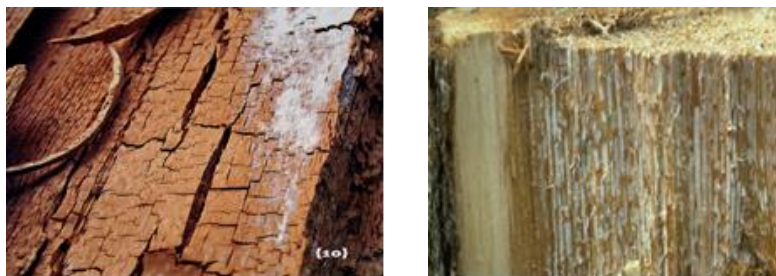
Рис. 6. Деструктивное и коррозионное разложение древесины
