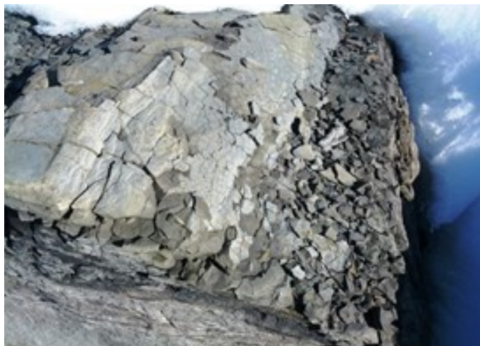
Рис. 1.9. Разуплотнение и распад аргиллитов на мелкие частицы (В Усть-Элегестинских отвалах)
