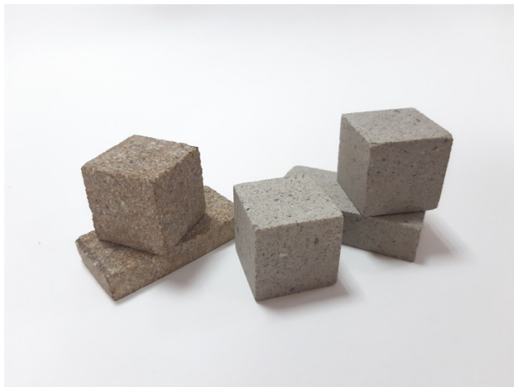
Рис. 1.7. Образцы каа-хемских (а) и межегейских (б) песчаников
