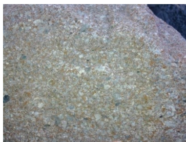
Рис. 1.6. Структура песчаников в отвалах Каа-Хемского угольного разреза:
