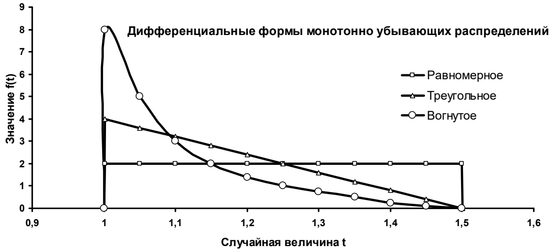
Рисунок 3.5 – Возможные монотонно убывающие кривые распределения плотности вероятности случайной продолжительности работы
