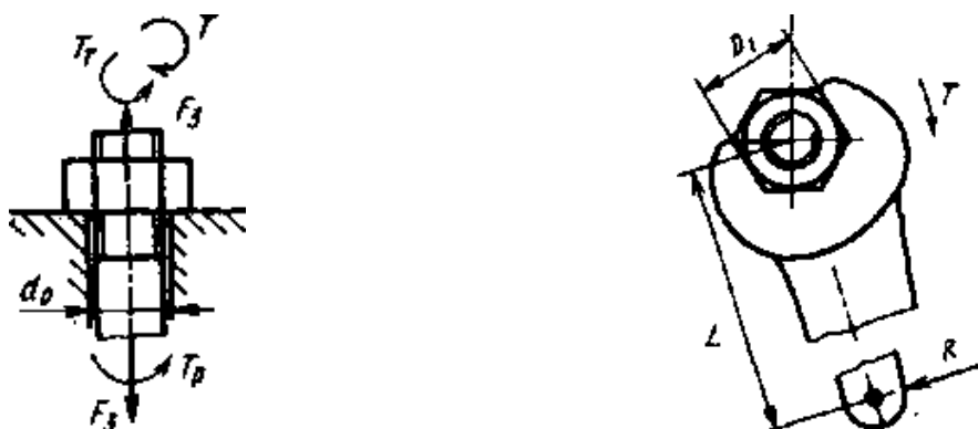
Рис. 3.3. Схема к анализу силовых факторов при затяжке резьбы ( T_T — момент трения по торцу гайки, T_p — момент в резьбе)
