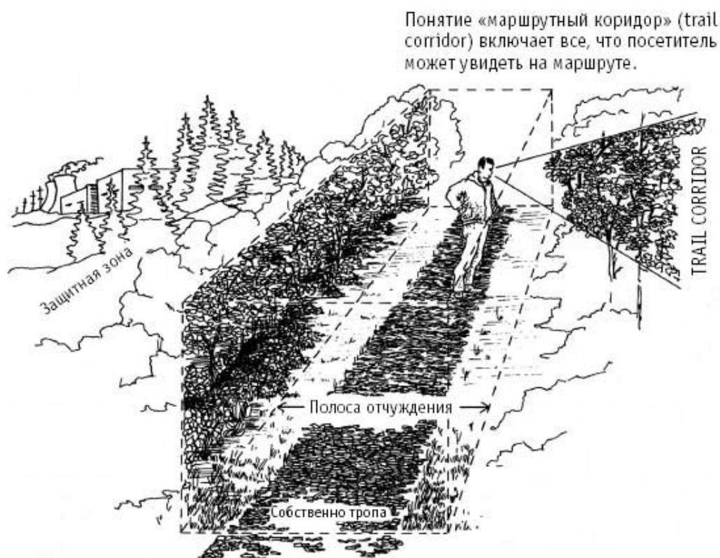
Рисунок 1. Схема маршрутного коридора
