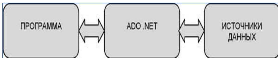
Рис.1.6. Роль ADO.NET в обеспечении доступа к данным.
