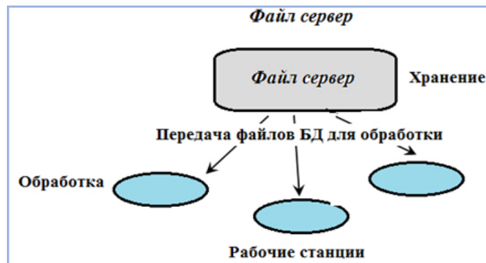
Рис. 1.1. БД с сетевым доступом (файл-сервер)
