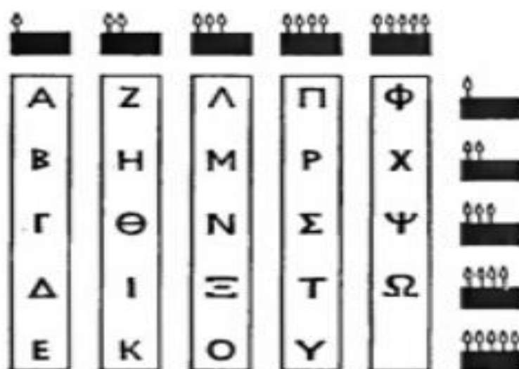
Рис.1 Схема кодирования букв греческого алфавита с помощью двух групп факелов.
