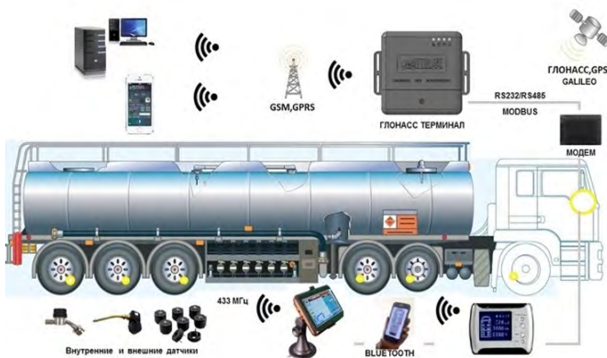
Рис. 4. Схема организации работы мониторинговой системы
