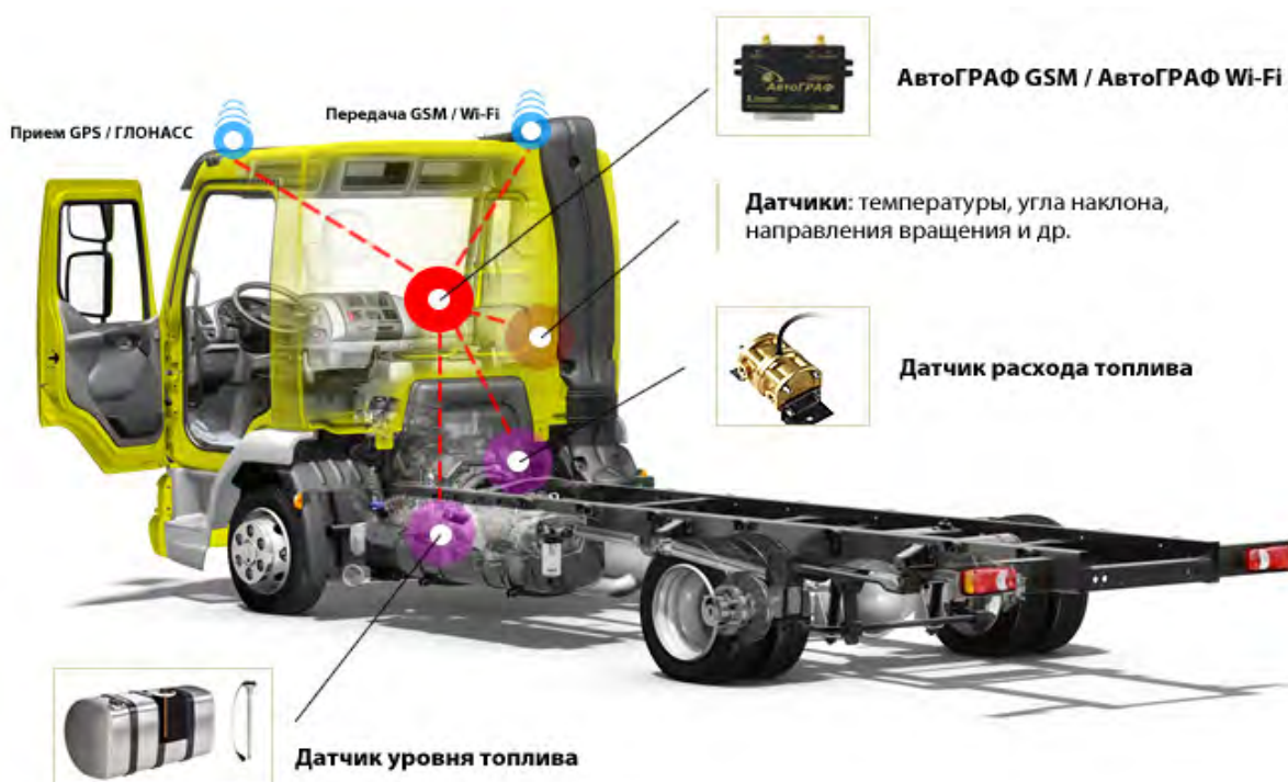
Рис. 6 Узлы и агрегаты взятые под контроль на сегодняшний день
