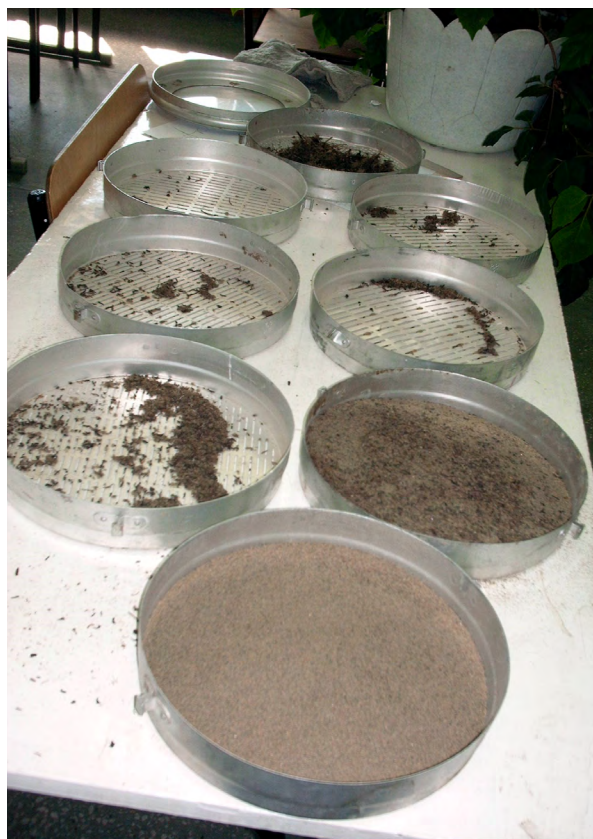
Рисунок 3 – Просеивание в почвенных ситах по фракциям почвенной пробы (фото оригинальные автора)
