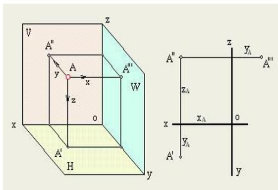
Рис. 1.3 Построение плоского чертежа точки  $A$
