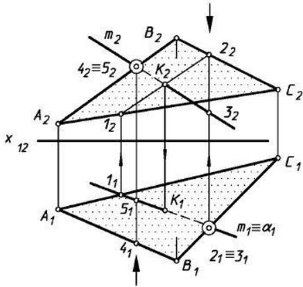
Рис. 7. Определение точки пересечения прямой с плоскостью
