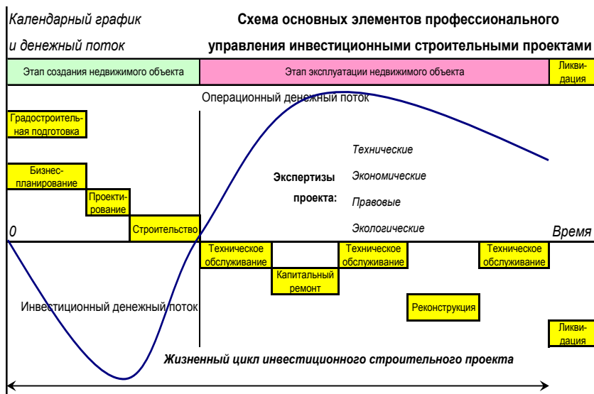
Рис. 4.1. Схема основных этапов жизненного цикла недвижимого объекта
