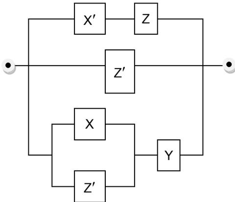
2.1.6. Проверить, равносильны ли следующие а) и б) релейно-контактные схемы:
