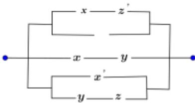
Данная схема состоит из трех параллельно соединенных ветвей, функция проводимости каждой из которых соответственно есть  $(xz') \vee y; xy, x' \vee (yz)$ . Тогда функция проводимости всей схемы есть их
