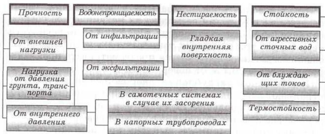
Рис. 4.3. Требования, предъявляемые к материалу труб сетей водоотведения
