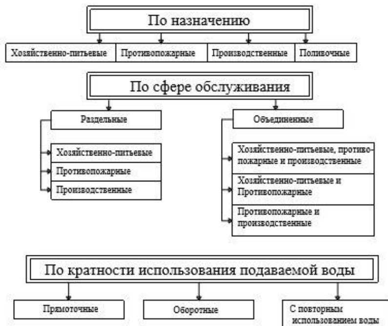
Рис. 2.1 Системы водоснабжения зданий
